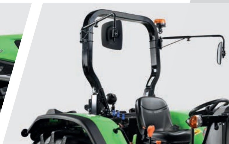
> Los retrovisores pueden instalarse en el arco ROPS.
