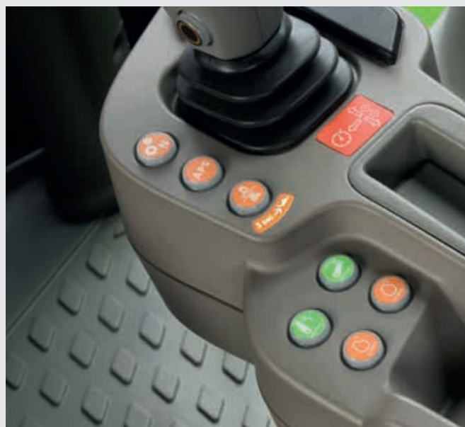
↑ Selección de modos de conducción Transporte, Campo, Reductora.
