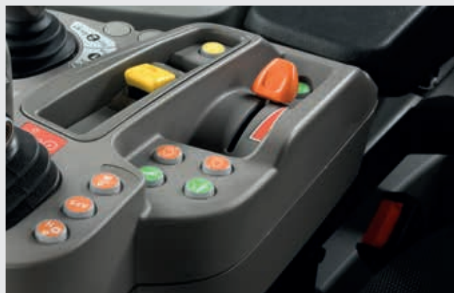
Acelerador electrónico de mano con 2 memorias de régimen del motor.
