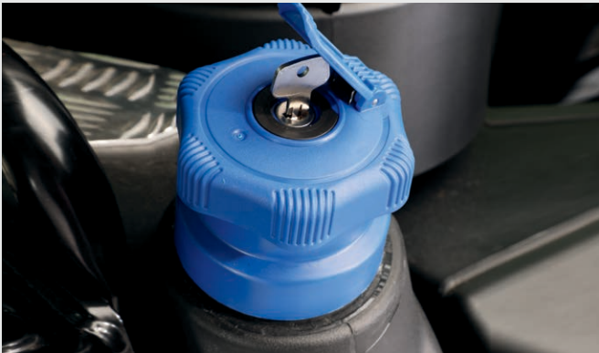
↑ Cubiertas con llave para los depósitos de combustible y AdBlue.
