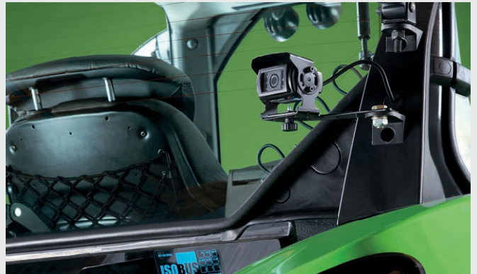
↑ Cámara integrada con modo automático de pantalla completa (p. ej. marcha atrás) para una mejor visibilidad y seguridad.
