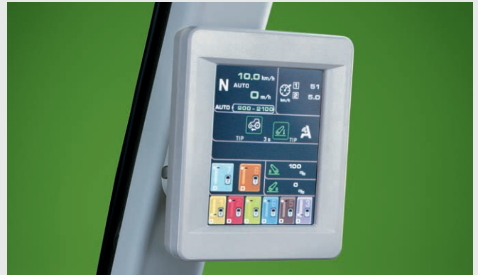
Se pueden seleccionar tres modos de conducción/trabajo: manual, automático y TDF. Se muestran en el WorkMonitor.
