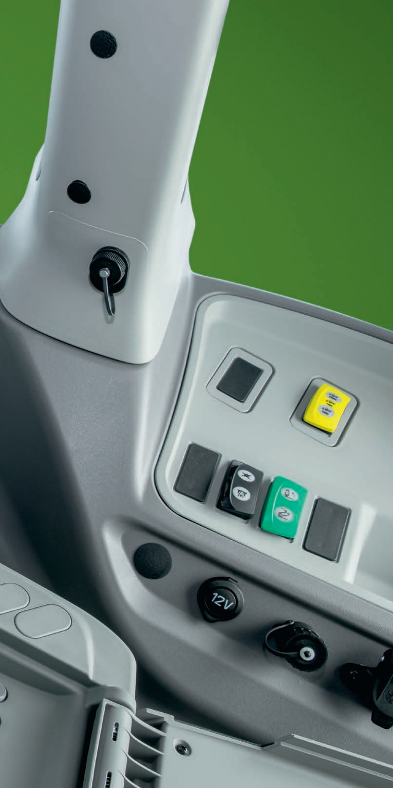
↑ La palanca de mando transversal con interruptores oscilantes controla tres distribuidores hidráulicos.
