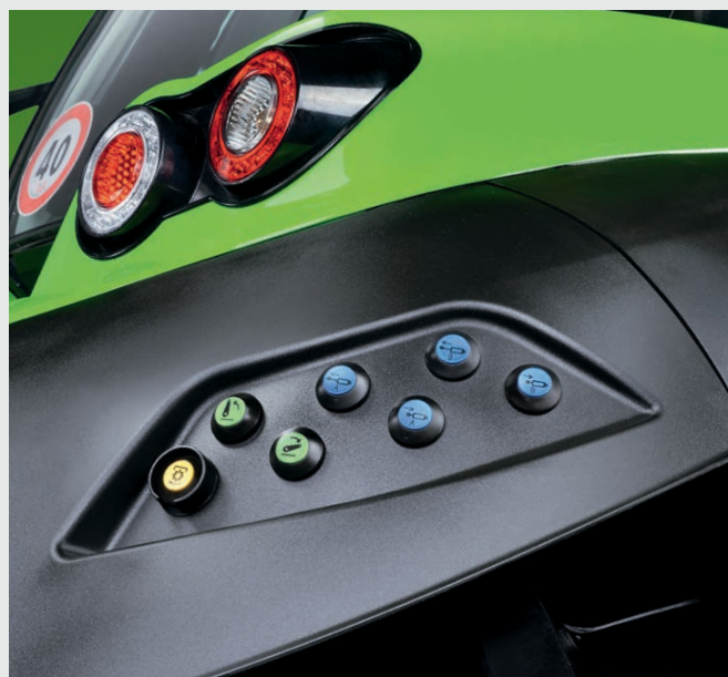
↑ Mandos externos de las funciones hidráulicas y de la TDF en ambos lados.
