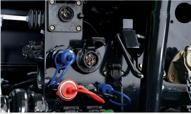
↑ Las interfaces ISOBUS de DEUTZ-FAHR en la parte delantera y en la trasera hacen que el tractor sea compatible con todos los implementos de los principales fabricantes.
