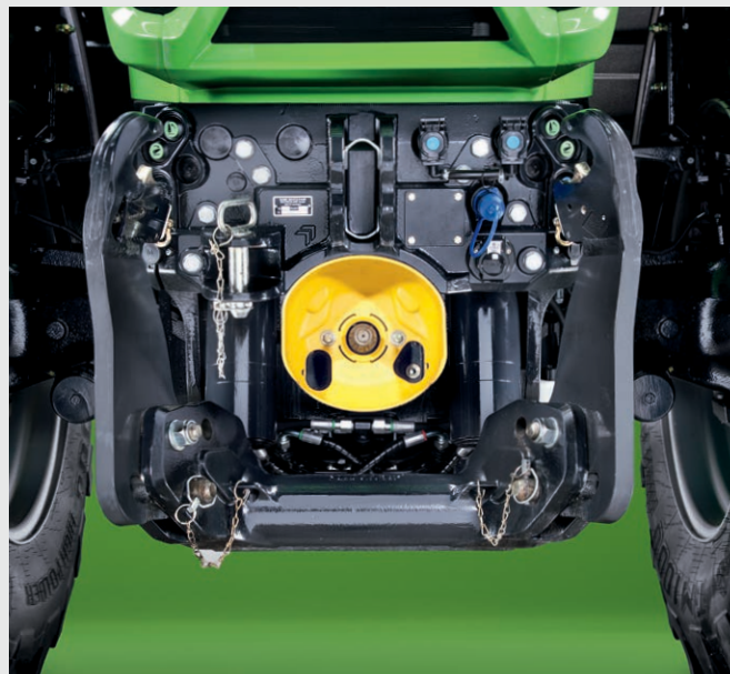
↑ Elevador delantero integrado a poquísimas distancia del eje delantero. Voladizo bajo. Mejor equilibrio del tractor.
