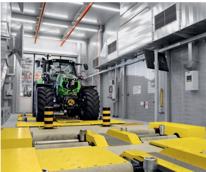
↑ Único en la fabricación de tractores: banco de pruebas con dinamómetro de chasis y suspensión de ejes.
