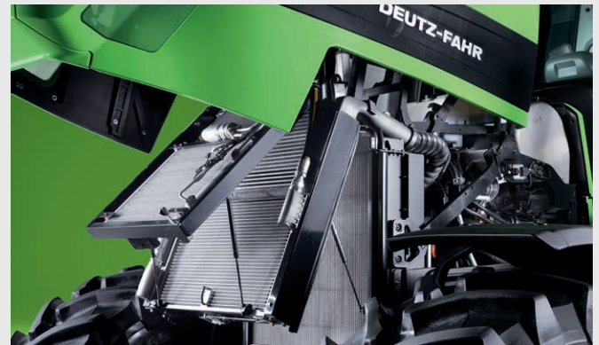
↑ El radiador del motor se puede abrir y limpiar fácilmente.
