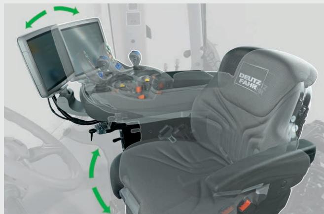
Novedad en todos los modelos TTV: Asiento con rotación de hasta 20° para mayor comodidad y facilidad de uso.
