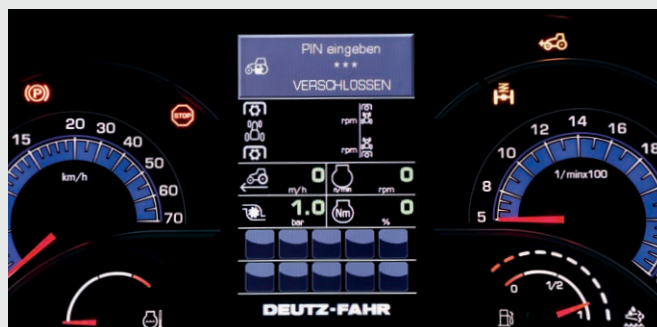
El nuevo InfoCenter mantiene siempre informado al conductor: información analógica y digital sobre el estado de funcionamiento. Seguridad gracias al bloqueo con código del tractor. Bloqueo y desbloqueo mediante PIN.
