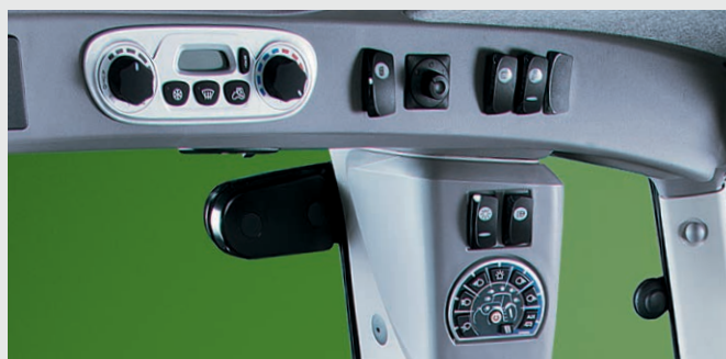
Luces de conducción, de trabajo y de cabina en un solo panel de control. Seleccione el clima de trabajo y la función automática controlará el caudal de aire.
