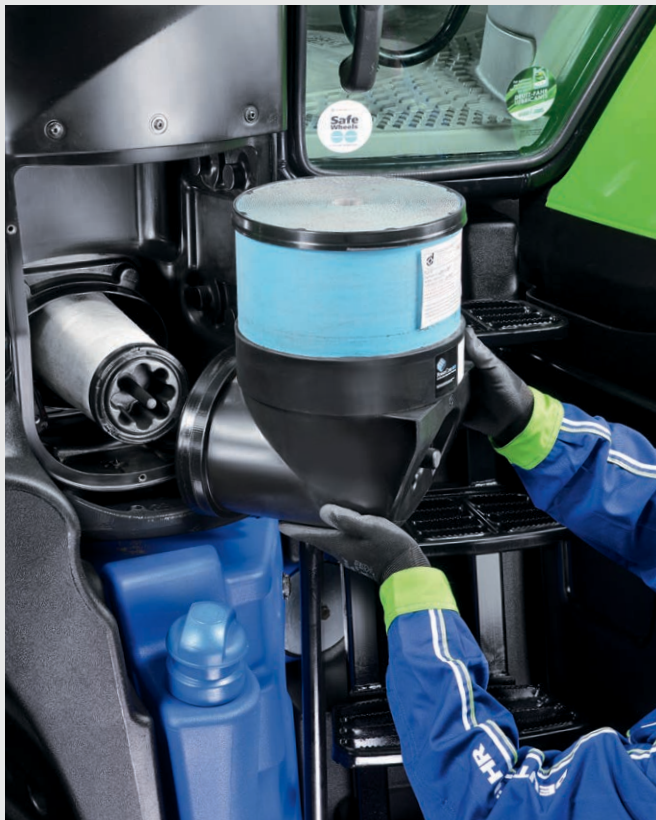
↑ El filtro de aire del motor es fácil de introducir y quitar.
