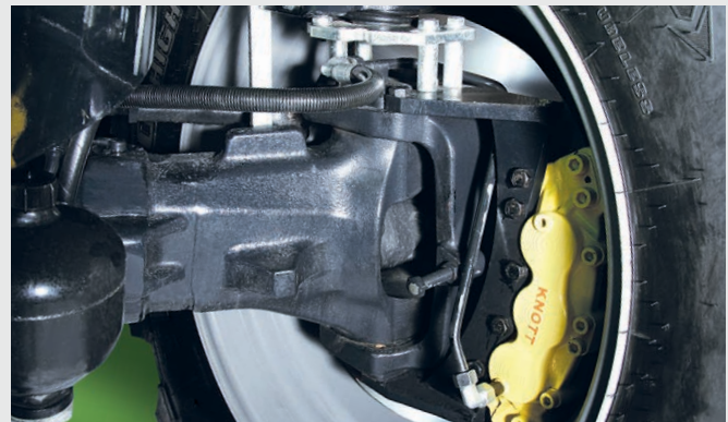
↑ Frenos de disco en seco en los ejes delanteros para una acción de frenado más segura (opcional).
