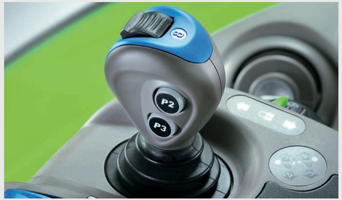
↑ La palanca de mando transversal con interruptores oscilantes controla tres distribuidores hidráulicos.
