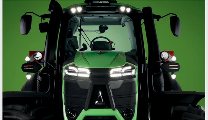
↑ Paquete de iluminación led de hasta 40.000 lm.
